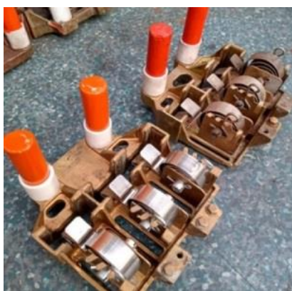
Figura 17 - Porta escovas dos motores de tração
